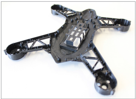
Toy State 设计团队利用 PC-ABS 材料 3D 打印具有高精度和强度的无人机框架
