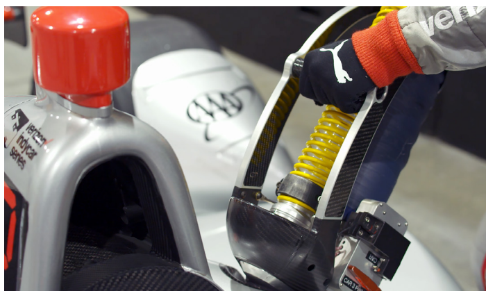
3D打印复合模具是能够按时生产新油枪把手的关键所在。
