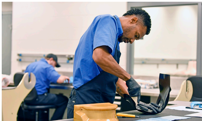
这个碳纤维零件是使用3D打印层合板工具制成的。
