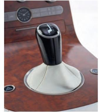
该原型汽车控制台上的木纹、人造革变速器罩及复杂表盘在 Stratasys J750 上通过单次打印而成。
