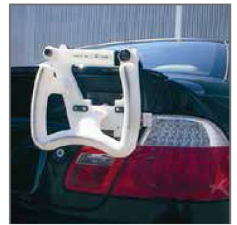
位于雷根斯堡的宝马公司的夹具和固定装置部门使用 Fortus 系统制造装配工具。 该工具用于固定汽车尾铭牌。
