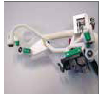
该工具采用直接数字制造技术制作,用于安装缓冲器支架。
