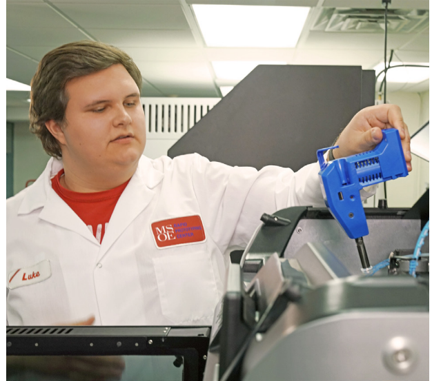
有了可互换打印头，可以轻松快速地转换到弹性材料打印。
