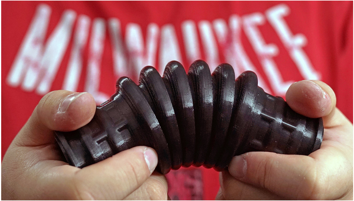
使用柔性FDM TPU 92A弹性材料打印的进气软管。
