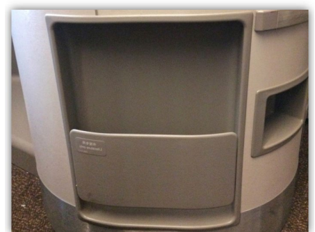
B777 公务舱书报架完成后期处理，装机使用
