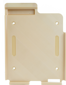
B777 驾驶舱“电子飞行数据包”支架 3D 打印制作完成
