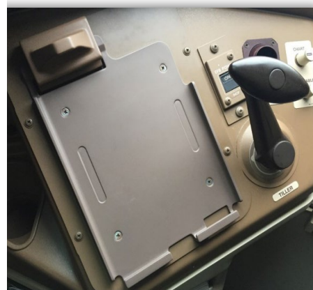
B777 驾驶舱“电子飞行数据包”支架完成后处理装机使用
