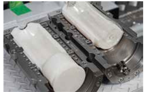
为缩短新塑料瓶试制开发的前置期，使用 3D 打印机制作的树脂模具
