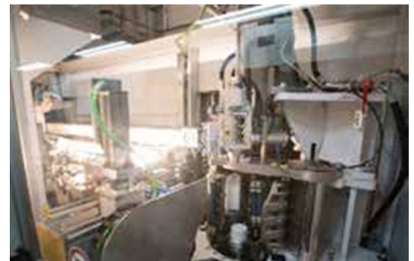
在制造塑料瓶时的“吹塑成型（为制作饮料瓶的中空形状而采用的塑料加工方法）”工序中，需要树脂模具能够承受加热器热度和空气压力
