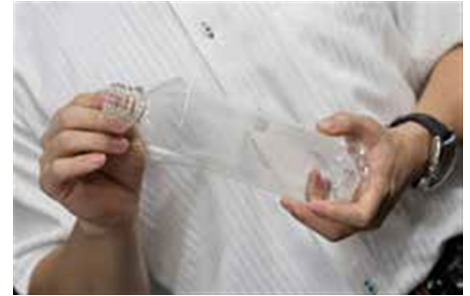
通过 3D 打印机制作的树脂模具，制作塑料瓶试制品
