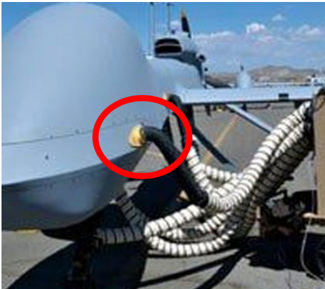
使用 ULTEM™ 9085 树脂材料 3D 打印的飞机管道。
