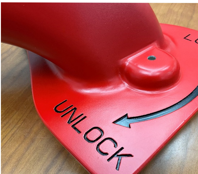
采用 FDM 增材技术制造的地面支撑设备。
