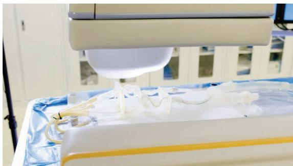
这种 3D 打印血管试验台模型可以为医疗设备设计师和工程师提供宝贵的设备性能反馈。
