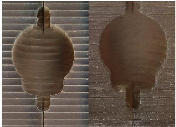
用于啮齿动物大脑解剖的 3D 打印切片板。分割夹具创建的切片为 2 毫米厚，插槽可使用 200 微米的刀片。
