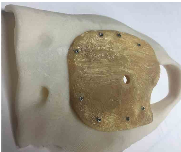
金色的 ULTEM™ 1010 树脂植入物贴合到马匹面部骨骼的模型上。
