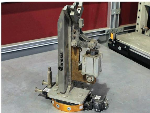
以传统方式机加工而成的金属终端执行器，笨重且庞大。
