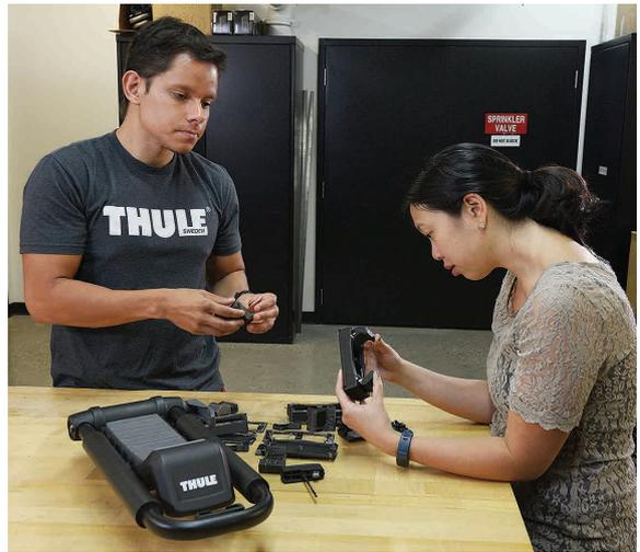
Thule 工程师使用 FDM Nylon 12CF（碳纤维）材料制作功能性原型。
