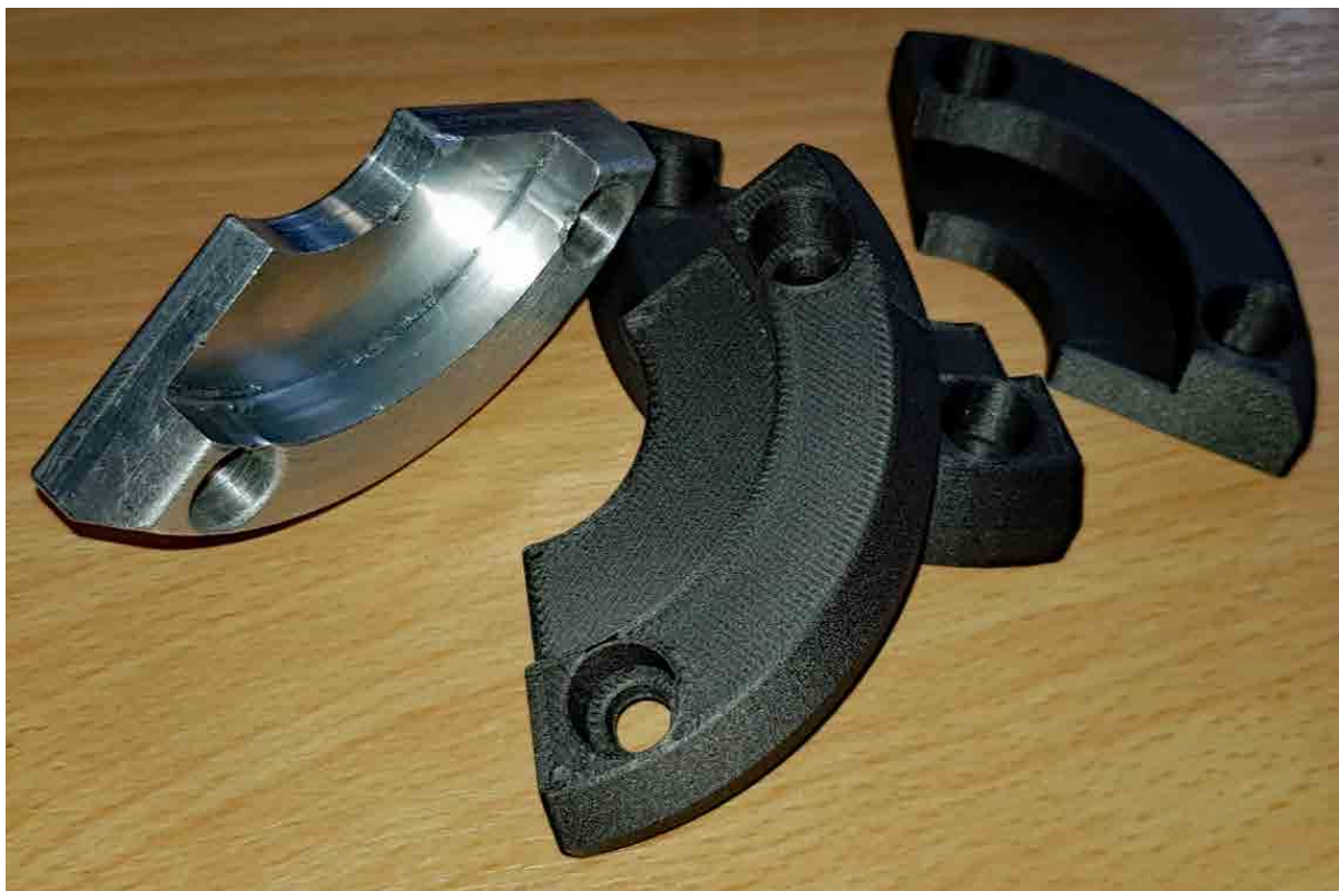
用 FDM Nylon 12CF 3D 打印的夹钳配件，这些零件能节省多达 80% 的机器设置时间。
