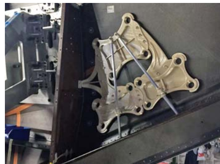
全新的3D打印制造工具采用坚韧的ULTEM 9085树脂材料，能够独立贴合曲面面板，解放了操作人员，缩短了客户交付时间。
