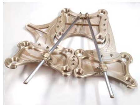
Indaero重新设计并3D打印了一个工具，比传统制造工具轻9公斤。
