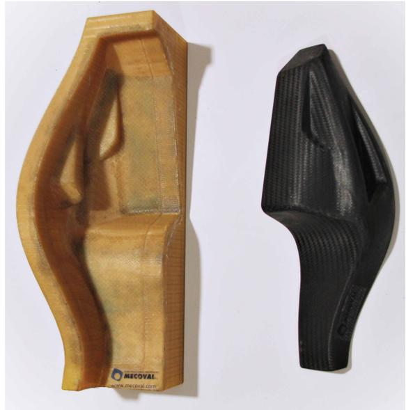
用 ULTEM™9085 树脂生产的 3D 打印复合材料铺层工具，用于一级方程式赛车的终端碳纤维零件。
