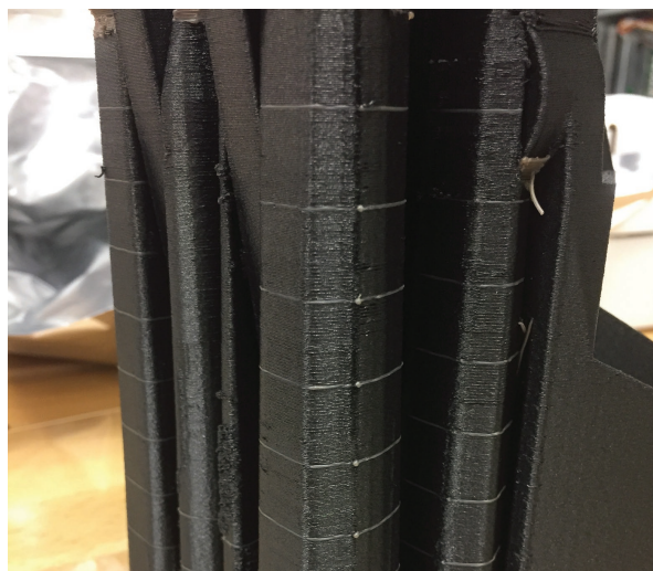
图 5：用稀疏支撑材料打印 FDM Nylon 12CF 零件时，尽可能使用模型作为支撑材料，且两层射孔的间隔为 0.5 英寸。
