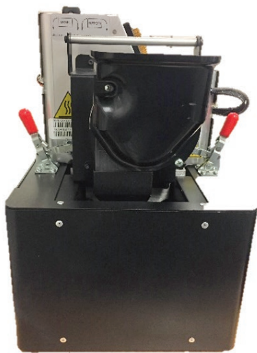
图 6: FDM Nylon 12CF 需要一个兼容的打印头组件。不使用打印头组件时，应将其妥善存放在对接容器中。
