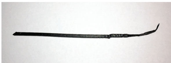
图 14：打印丝的一段出现扭结，这可能与打印暂停警告“模型打印丝堵塞在打印头”相对应。
