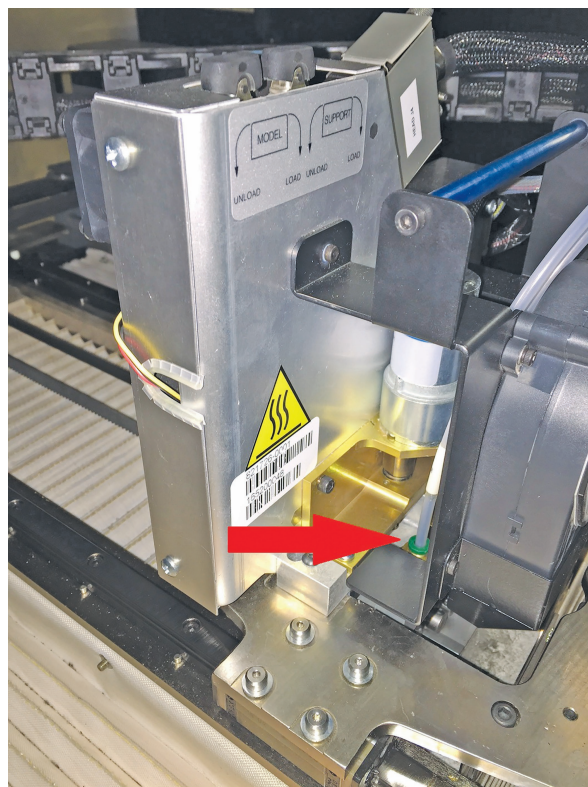
图 13: 模型侧管配件用于释放打印丝导管。
