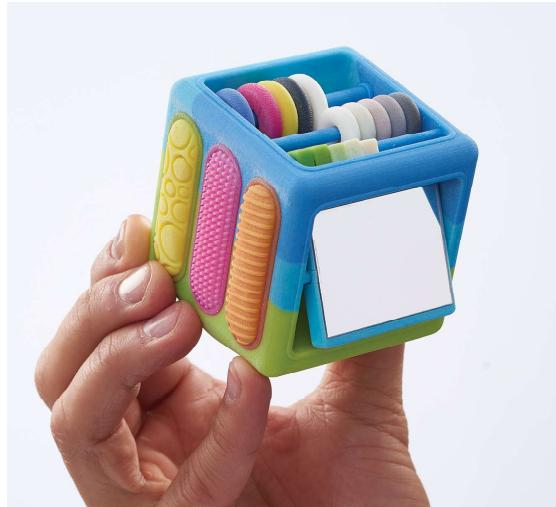
3D打印的概念模型可以具有多种颜色、高级纹理和移动部件。
