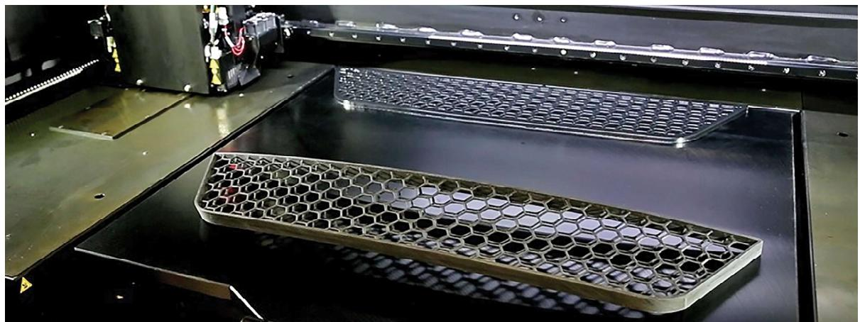
3D打印一体式汽车格栅示例。
