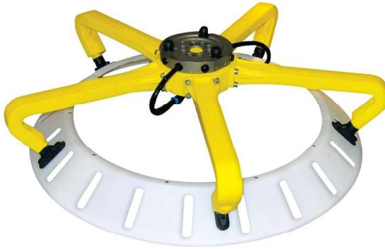
通过使用3D打印重新制造带有内部真空通道的夹具，Digital Mechanics消除了阻碍操作的五个外部软管。
