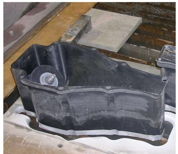
顶级的美国纳斯卡赛车乔·吉布斯车队使用FDM制造夹具，其中一些已经投入使用超过两年，交付时间和费用平均减少了70%。
