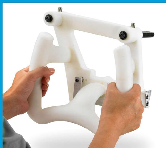
BMW可以使用FDM打印传统加工和制造所无法实现的夹具和固定装置。AM让它们更易于使用，功能更强大。
