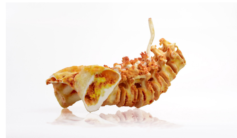
含整形外科植入物的该下脊椎模型以 3D 打印技术打印，带有纹理图，使用较暗的颜色来表示组织密度。
