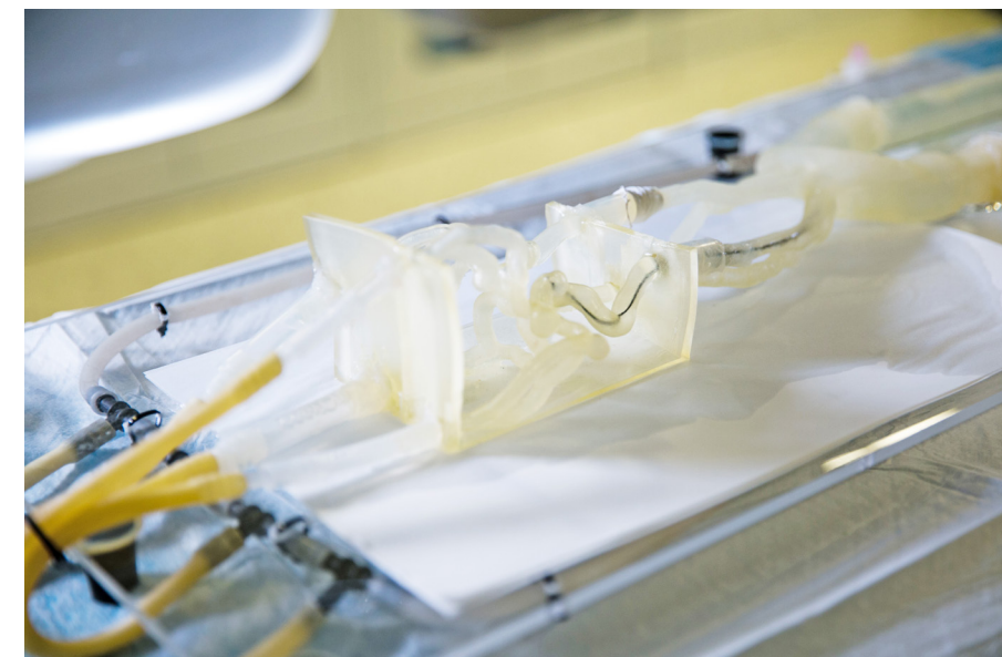
该血管模型的透明柔性材料用于在对患者进行手术前评估拟定动脉瘤治疗方案的可行性。
